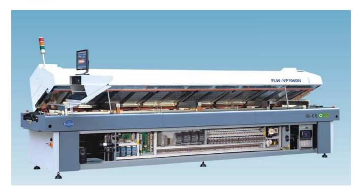
Forno a 24 zone con temperatura controllata: 20 zone di riscaldamento forzata (10 superiori e 10 inferiori) + 4 aria /
